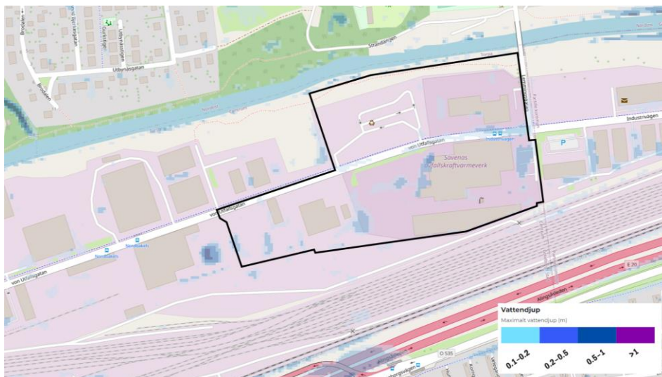
Figur 2-11. Befintlig översvämningsituation vid klimatanpassat 100-årsregn (Göteborgs stad, 2023).
