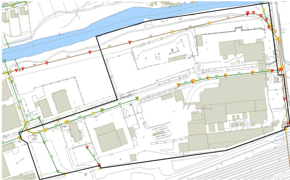
Figur 2-5. Befintligt ledningsnät inom planområdet. Trianglar visar vattennivåer i ledningsnätet vid ett 30-årsregn. Grön markering indikerar vattennivåer under ledningens hjässa, gul över hjässan och röd över marknivå.
